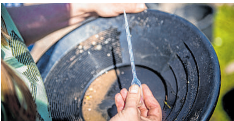
Sind die Goldflitter in der Waschpfanne erst mal identifiziert, werden sie mit einer Pipette vorsichtig herausgesogen.
